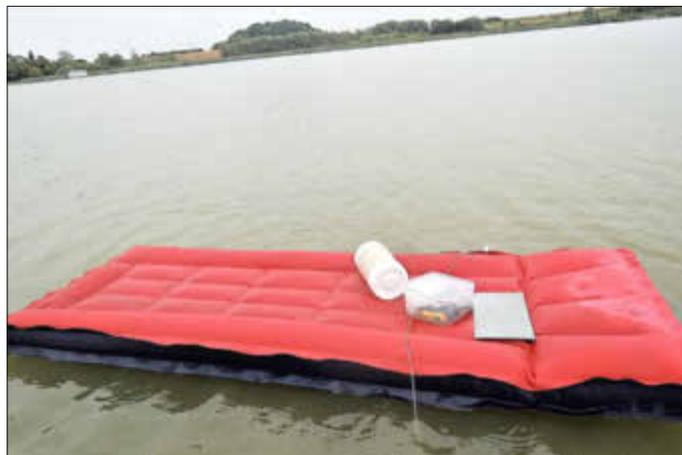
Eine Luftmatratze als „Arbeitsplattform“ mit wasserdichten Behältnissen für Fotoapparat, Kompass, Bandmaße und Schreibgerät sowie Blechplatte als Papierersatz bei Vermessung und Fotografieren der Hungerstein
