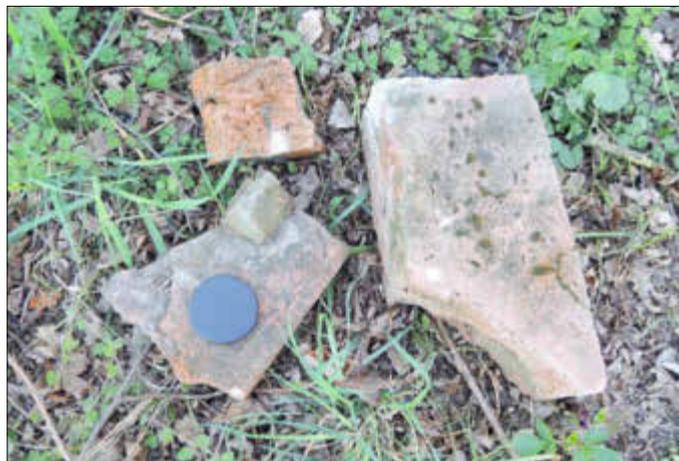
**Backsteinbruchstücke, darunter Biberschwanz-Dachstein mit Zapfen zum Einhängen an der Dachlattung sowie ein Klosterformat-Ziegelstein. Der Kameraobjektivdeckel soll dem Größenvergleich dienen.**
