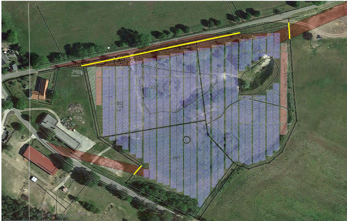
Abbildung 14: Auftretende relevante Reflexionen in Rot, mögliche Sichtunterbrechungen in Gelb
